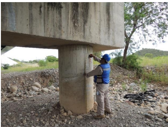
Figura 6.5-23. Levantamiento geométrico de la subestructura
