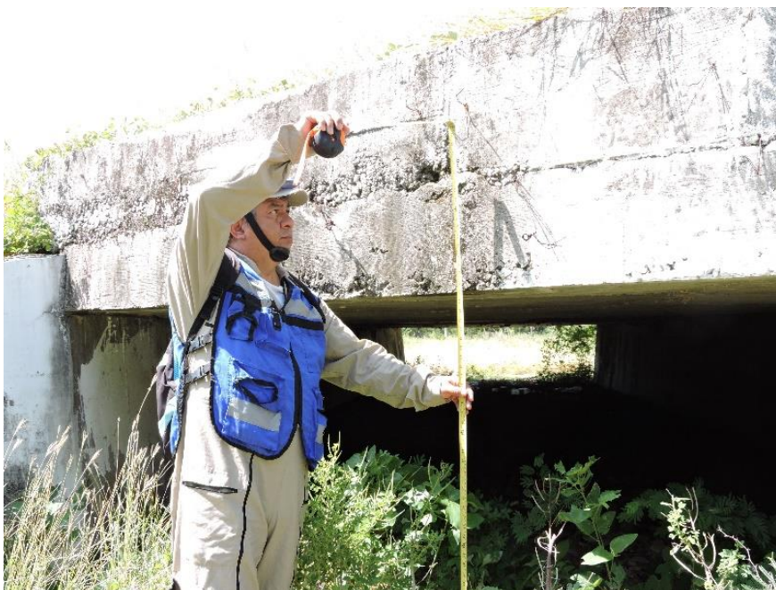
Figura 6.5-32. Verificación del espacio libre vertical del puente
