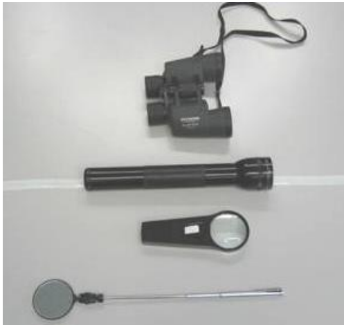
Figura 6.3-5. Equipo de inspección
