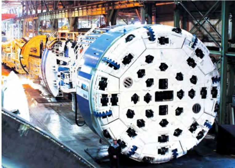
Figura 7.50. Máquina Tuneladora y cabeza de corte. Cortesía de Robbins.
