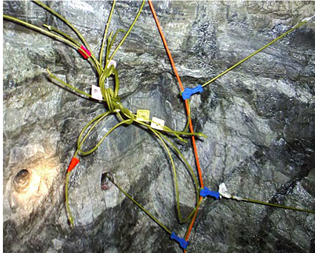
Figura 7.13. Conexión línea troncal.
