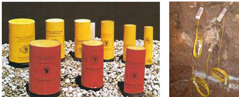
Figura 7.23. Iniciadores de alta presión de detonación (Boosters) y emulsiones.
