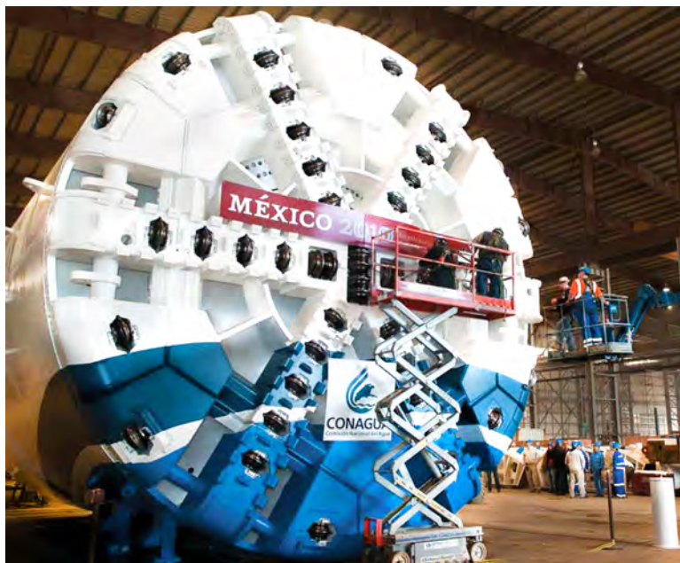
Figura 7.55. TBM Tipo escudo utilizada en TEO (Túnel emisor Oriente). Cortesía de Robbins.
