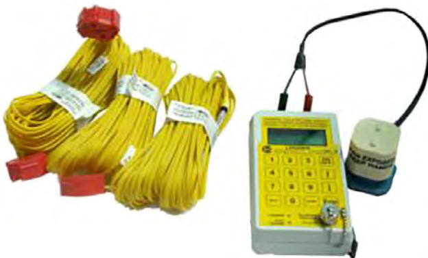
Figura 7.34. Iniciadores electrónicos y programador de tiempos.
