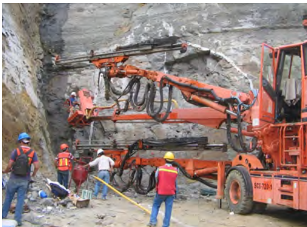
Figura 7.10 Jumbo. montado sobre neumáticos.
