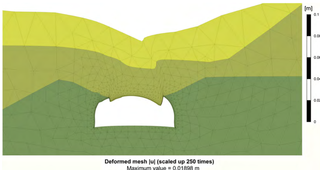
Figura 6.39. Colapso de modelo sin sostenimiento.
