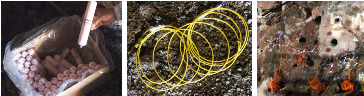
Figura 18.40. Explosivo (izquierda), mechas o guías de detonación (centro) y cordones detonantes (derecha).
