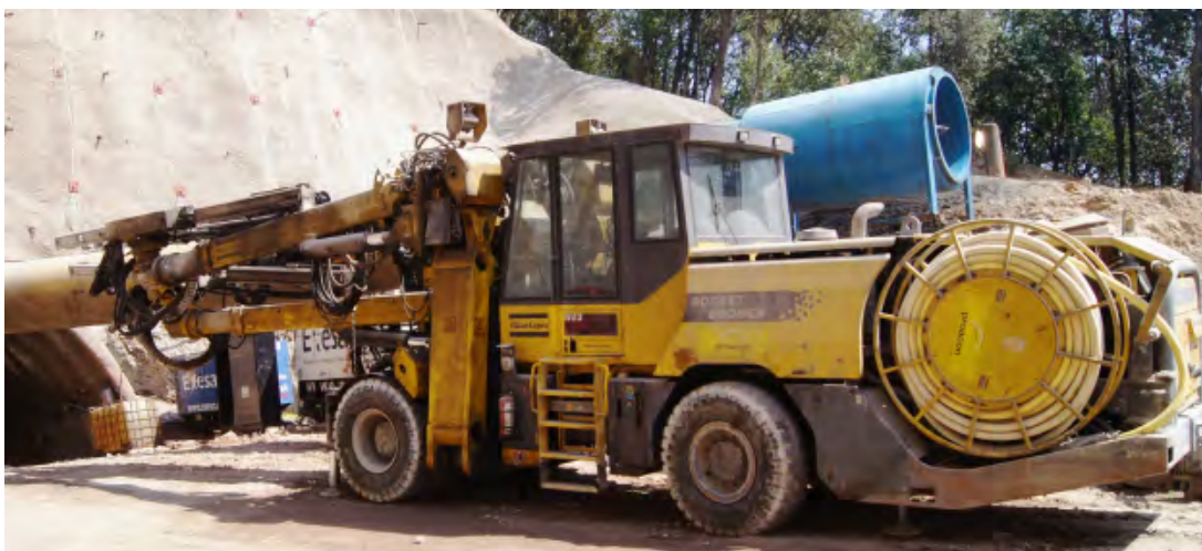
Figura 18.20. Jumbo equipado con dos extintores ubicados a ambos costados del mismo.
