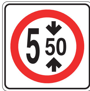
Figura 17.13. SR-15 Altura libre restringida.
