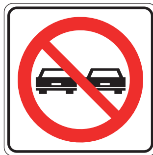
Figura 17.14. SR-18 Prohibido rebasar.
