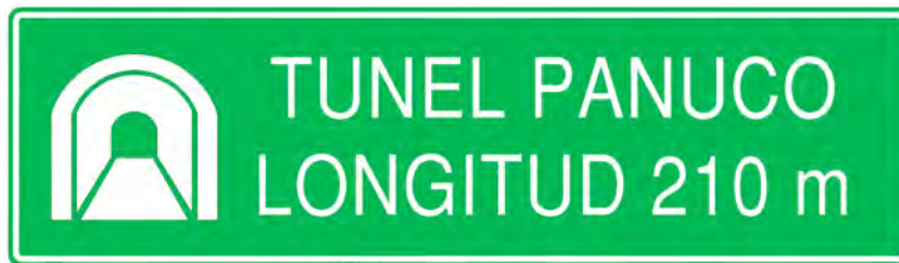
Figura 17.16. Señal 1 Nombre del túnel (túneles cortos).
