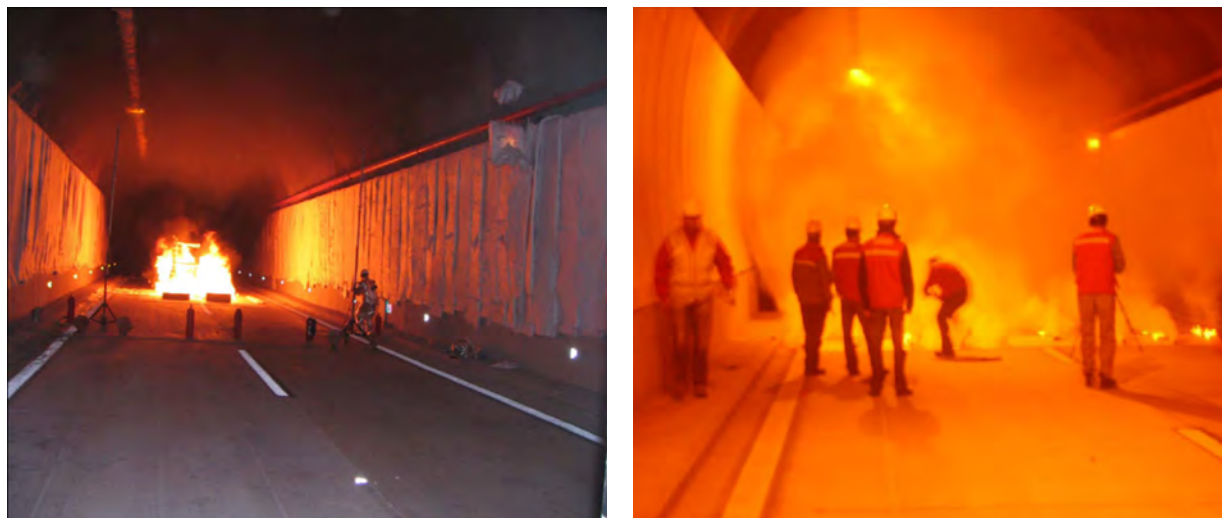
Figura 16.11. Ensayo de humos.
