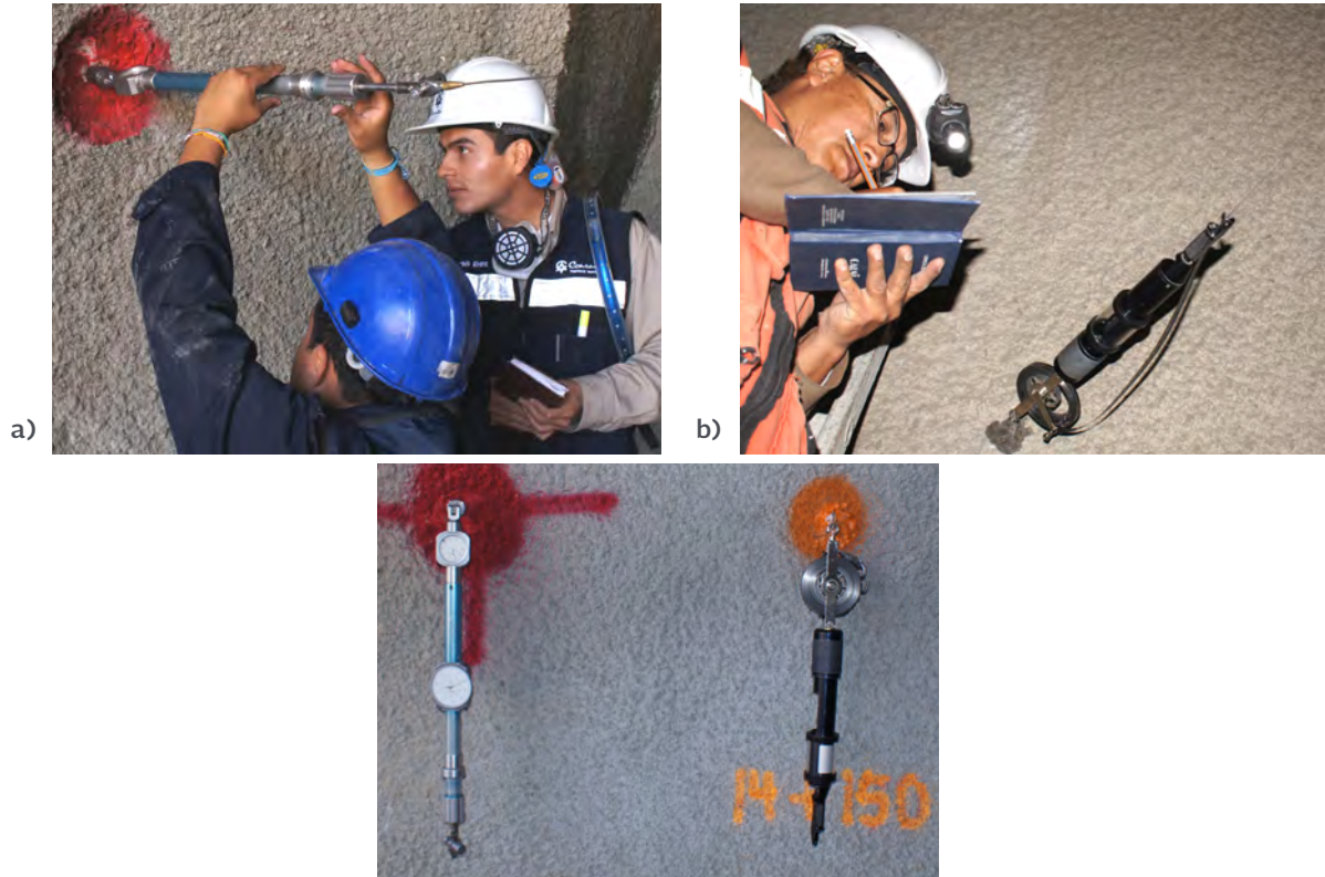
Figura 13.13. Equipos de medición: a) Distometer y b) Cinta Extensométrica.
