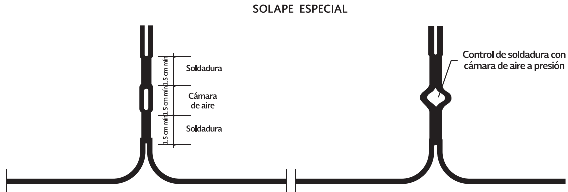
Figura 12.14. Solape especial con canal central.
