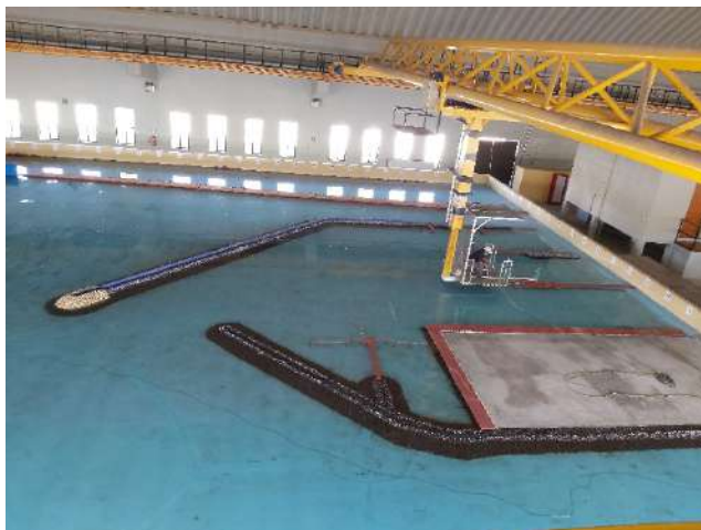
Foto: Modelo hidráulico de agitación de oleaje, Salina Cruz, en Oaxaca.
