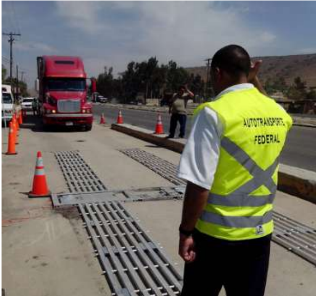
Foto: Verificación de peso y dimensiones a vehículos de carga que transitan en las carreteras federales.
