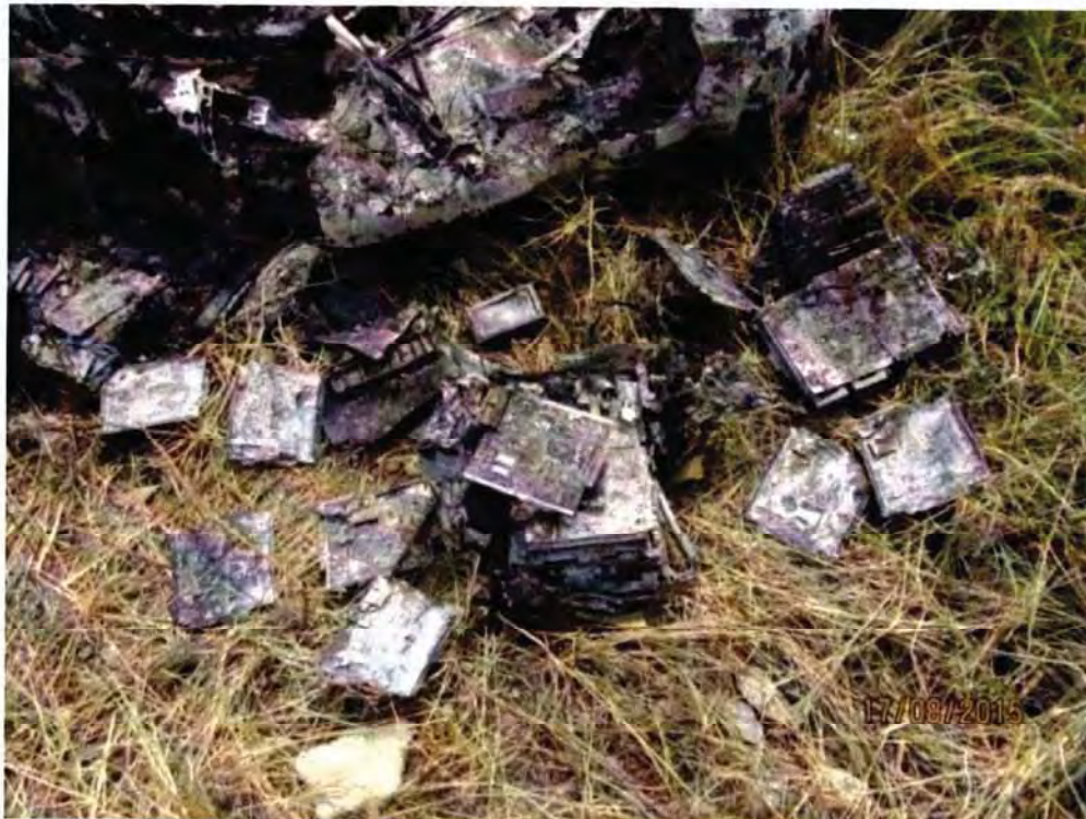
Condiciones en que quedaron las memorias volátiles dañadas por el fuego
