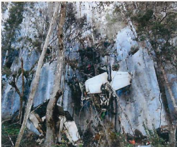
Restos del Estabilizador Horizontal, ocultando parte inferior de panel de Instrumentos.
