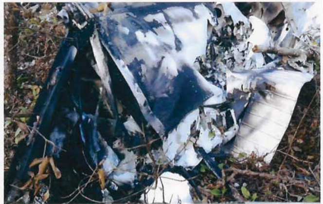
Restos Semi ala derecha parcialmente calcinados.
