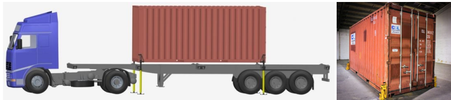
Fig. A2. Sistemas de pesaje de los contenedores llenos utilizando básculas elevadoras de pistón
