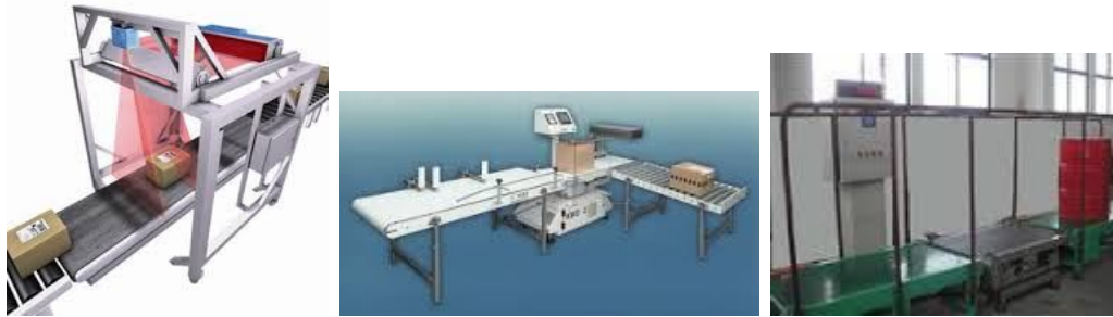
Fig. A4. Sistema de pesaje de bultos utilizando básculas comprobadoras operando en régimen dinámico.
